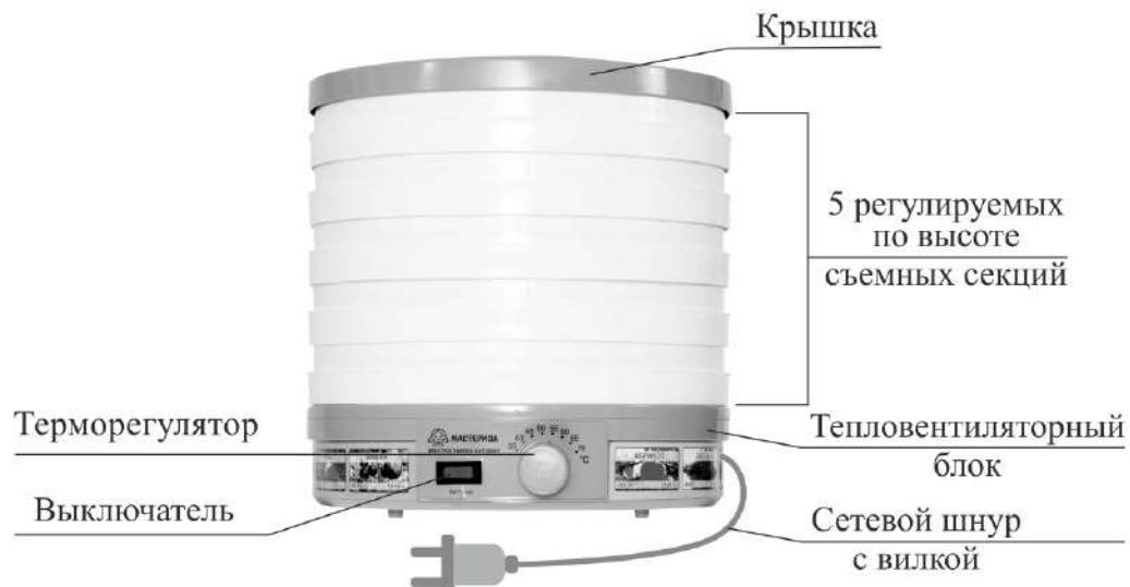
Внутри тепловентиляторного блока размещены электродвигатель с крыльчаткой и электронагреватель. Вентилятор закачивает воздух из нижней части электросушилки и подает его на нагреватель, где воздух нагревается и через крышку с жалюзиями подается на решета. Терморегулятор служит для поддержания заданной температуры воздуха.
