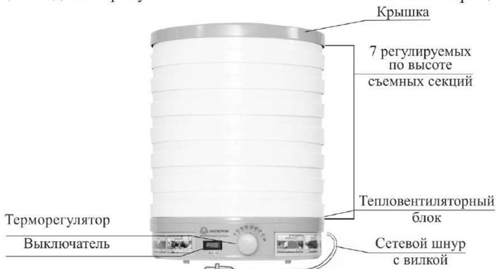
Внутри тепловентиляторного блока размещены электродвигатель с крыльчаткой и электронагреватель. Вентилятор закачивает воздух из нижней части электросушилки и подает его на нагреватель, где воздух нагревается и через крышку с жалюзями подается на решета. Терморегулятор служит для поддержания заданной температуры воздуха.
